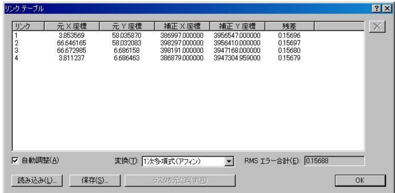
図. 1 1 4 点すべての補正 X 座標、Y 座標を貼り付けたところ
