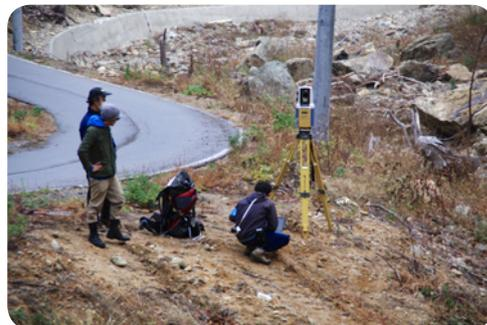
プロジェクトメンバーが姉吉の谷で地上型レーザスキャナを用いて測量を行っている場面。
