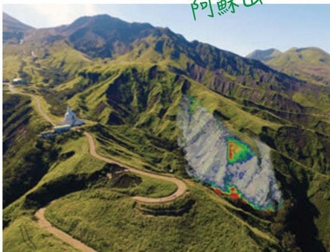
阿蘇山北麓の仙酔峡において、降雨や地震によって発生した斜面崩壊の変化を、地上レーザ測量やUAS（無人航空機）を用いたSfM多視点ステレオ写真測量といった手法を用いて、多時期に渡る高精細空間計測により明らかにします。
