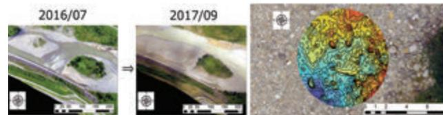
石川県白山市の手取川にて、土砂移動や河道の変化と降雨・水位変動との関係を、UAS（無人航空機・ドローン）を用いた高頻度・高空間解像度計測により明らかにします。
